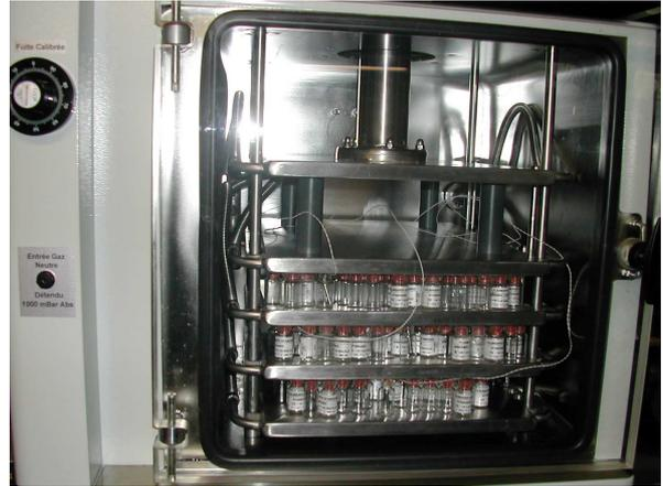
Ce dispositif permet de boucher des vials équipés de bouchons en fin de lyophilisation.
